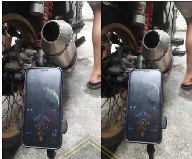
Gambar 4.6 Pengukuran dB Meter Motor Balap honda Tiger 200 cc
