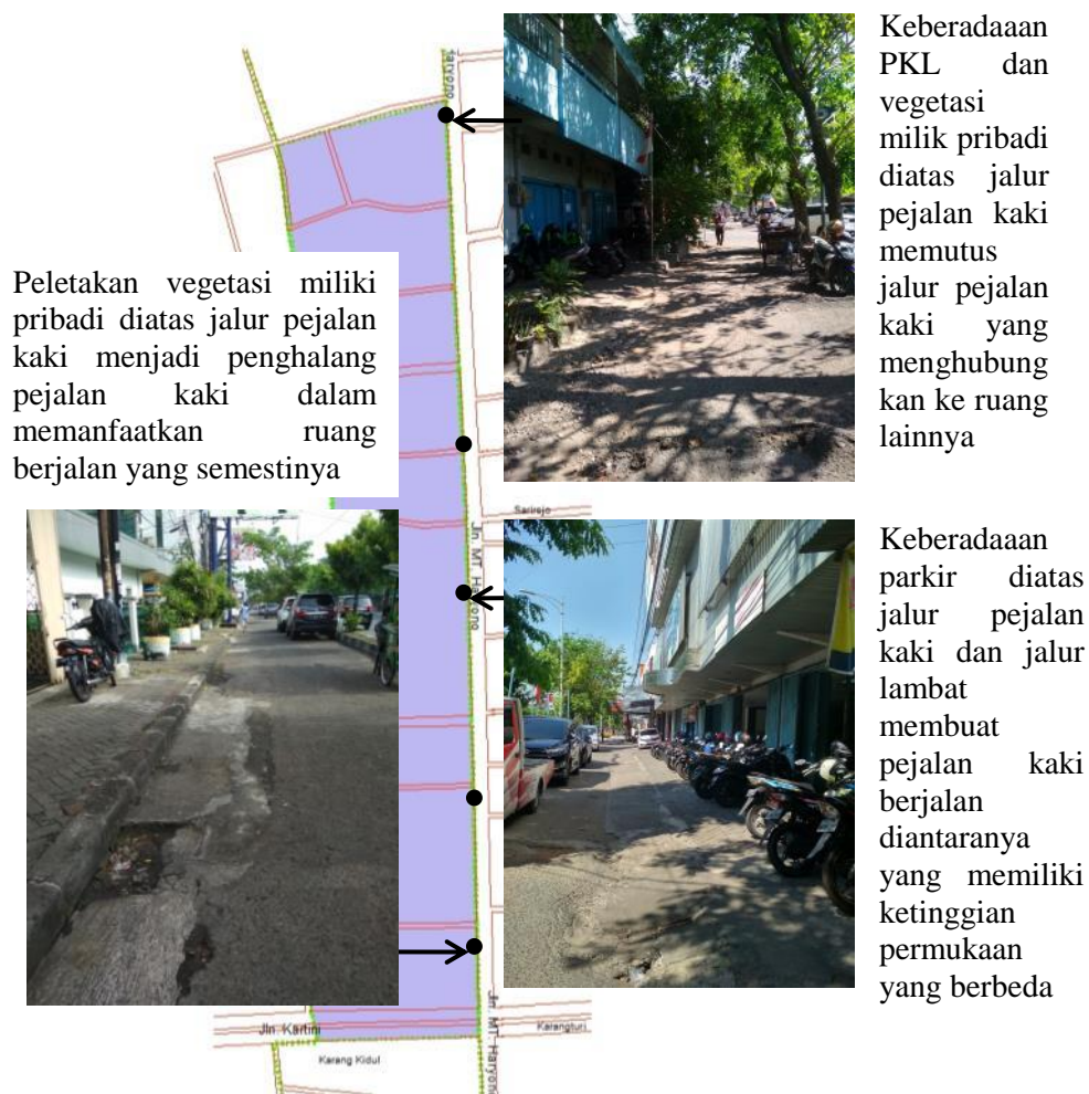
Gambar 4.14 Sebaran Penghambat Sirkulasi Pejalan Kaki di Jalur Pejalan Kaki MT. Haryono Segmen II Sumber: Hasil Observasi, 2021
