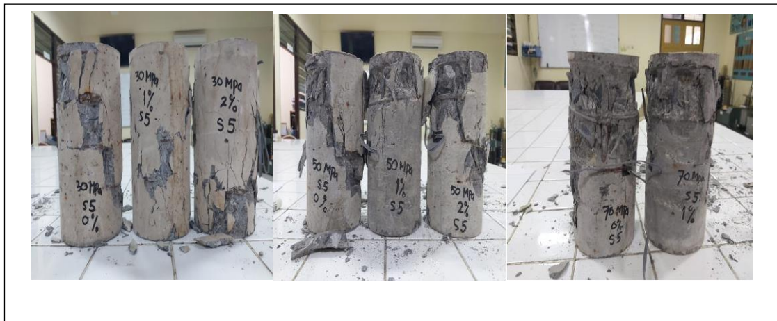
Gambar 5. 79 Keruntuhan Beton Serat Terkekang Tanpa Bakar Senggang S50
