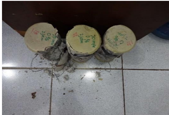
Gambar 3. 18. Visual Hasil Uji Tekan Beton
