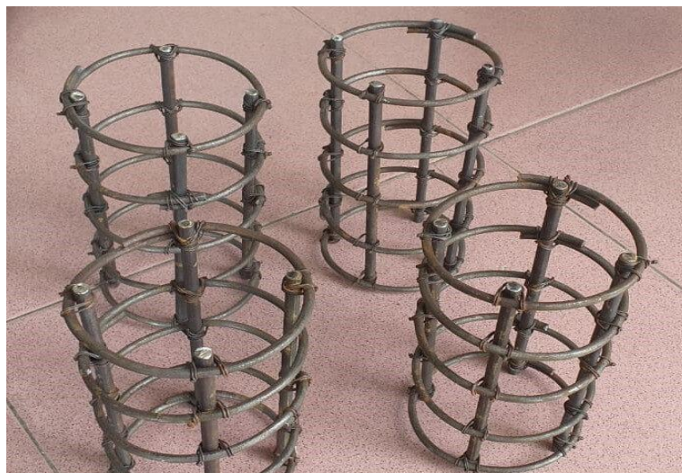
Gambar 3.1 Pengekangan Tulangan Spasi 50 mm
