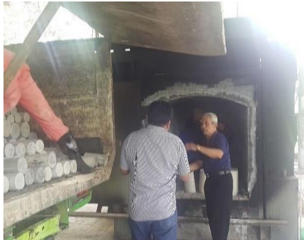
Gambar 4. 12 Proses Penataan Benda Uji
