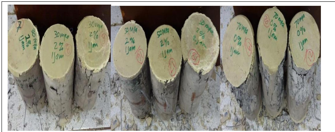
Gambar 5. 4 Jenis Keruntuhan Beton Normal Pasca Bakar 1 Jam
