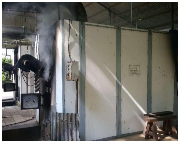
Gambar 4. 14 Proses Pembakaran Benda Uji
