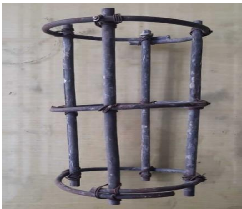
Gambar 3.2 Pengekangan tulangan Spasi 100 mm
