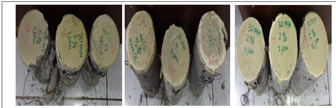
Gambar 5. 5. Jenis Keruntuhan Beton Normal Pasca Bakar 2 Jam
