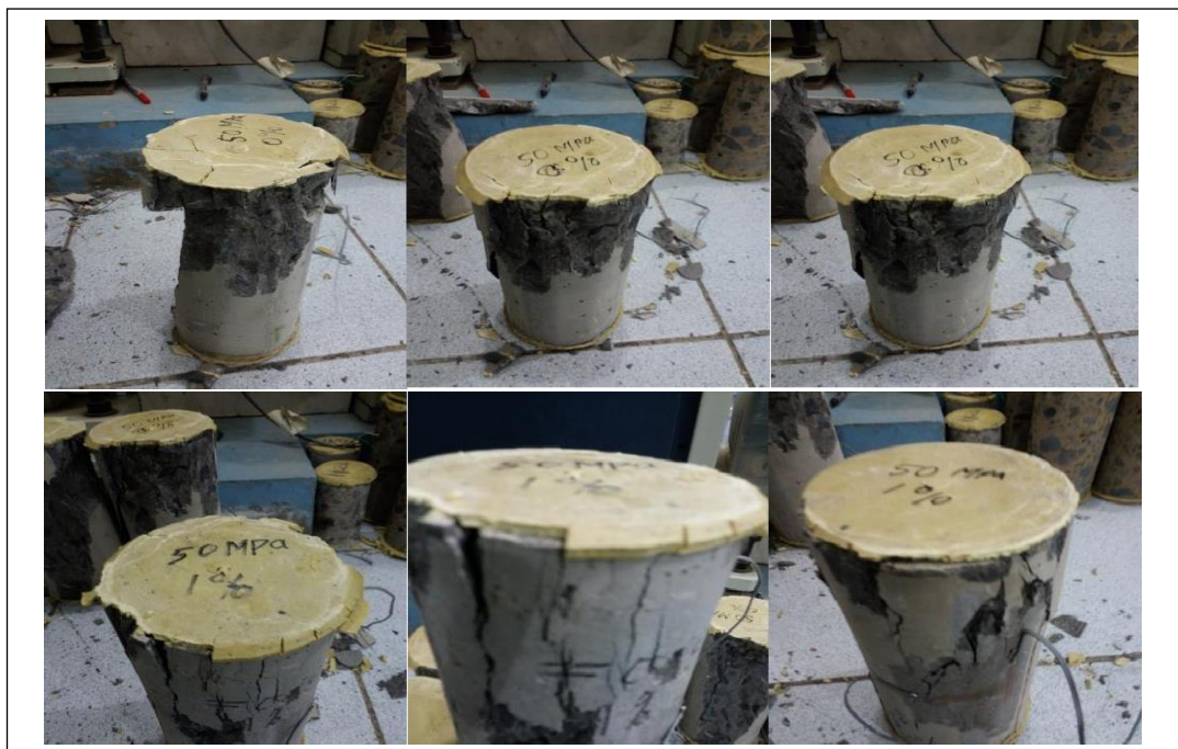
Gambar 5. 2 Jenis Keruntuhan Beton Tak Kekang Tanpa Bakar MSC
