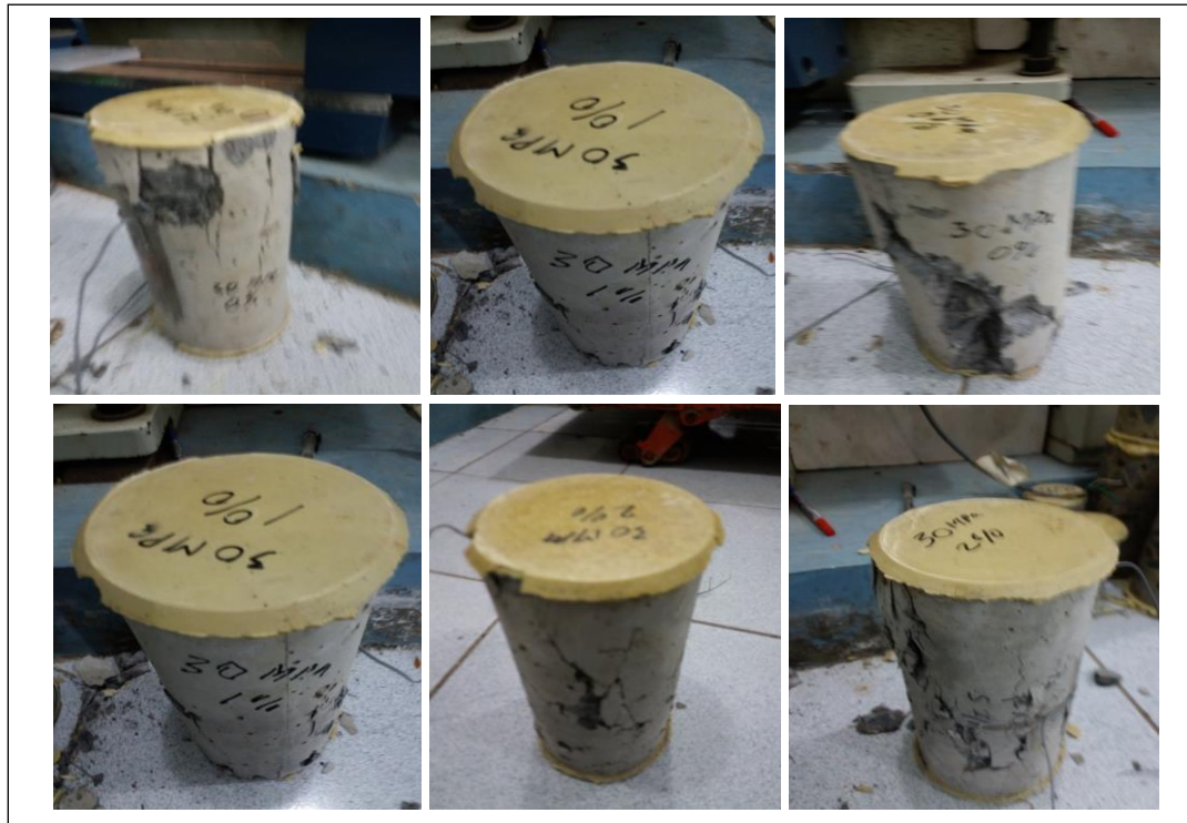
Gambar 5. 1. Jenis Keruntuhan Beton Tak Kekang Tanpa Bakar NSC
