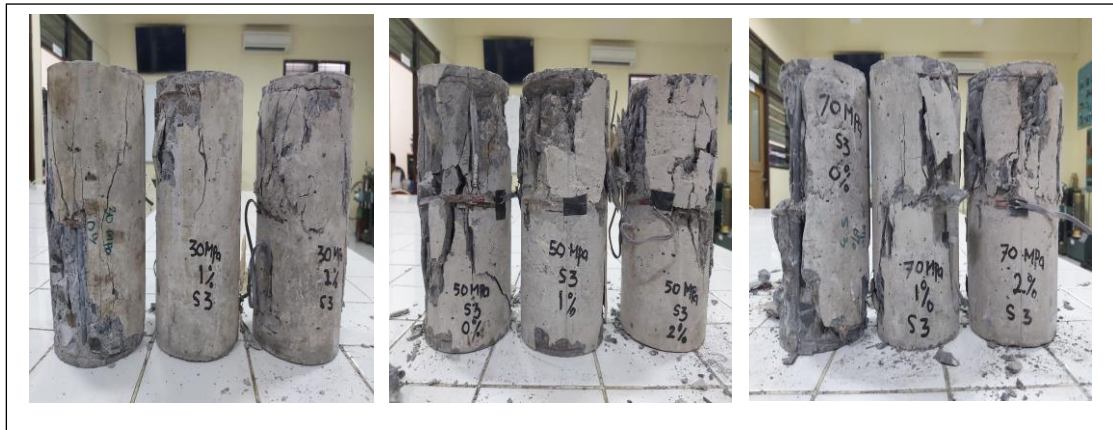
Gambar 5. 77 Keruntuhan Beton Serat Terkekang Tanpa Bakar Spasi100
