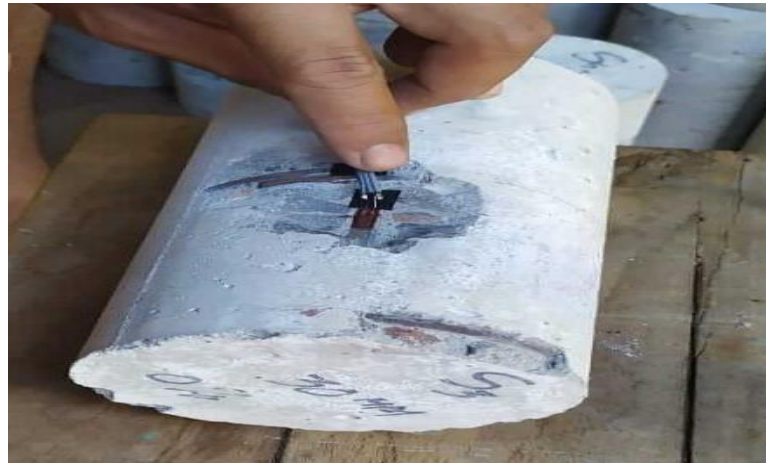
Gambar 3. 10. Pemasangan Strain Gauge Pada Tulangan Longitudinal
