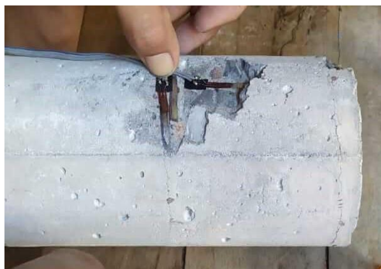
Gambar 3. 11. Pemasangan Strain Gauge Pada Tulangan Senggang
