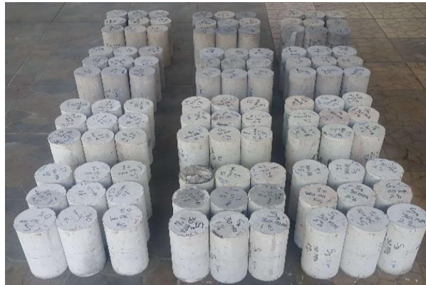
Gambar 4. 29. Penomoran Beton Pasca Bakar
