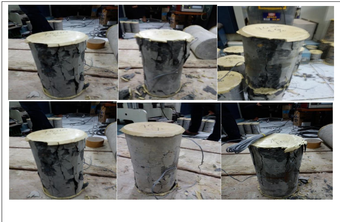
Gambar 5. 3. Jenis Keruntuhan Beton Tak Terkekang Tanpa Bakar HSC
