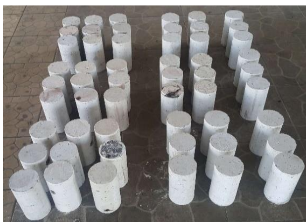
Gambar 4. 20. Beton Pasca Bakar
