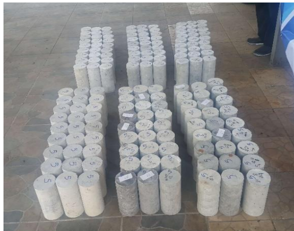
Gambar 4. 24. Beton S100 dan S50
