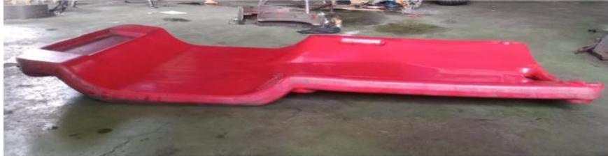
Gambar 4.38 Alat Bantu Creeper
