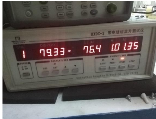
Gambar 3. 15 Proses Pengukuran Dengan Hot Winding
