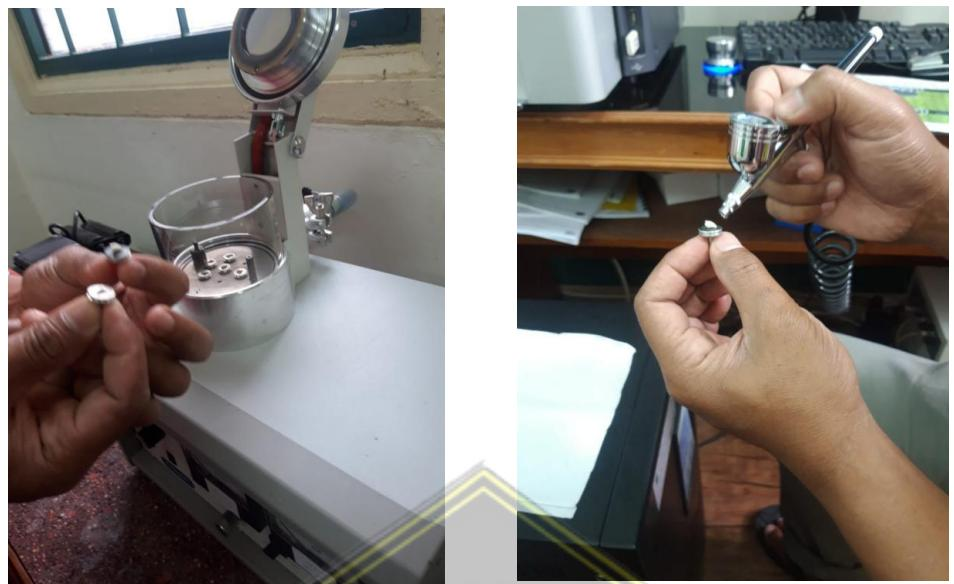
Sampel dilakukan pengujian sem dan dimasukan pada SEM pro x
