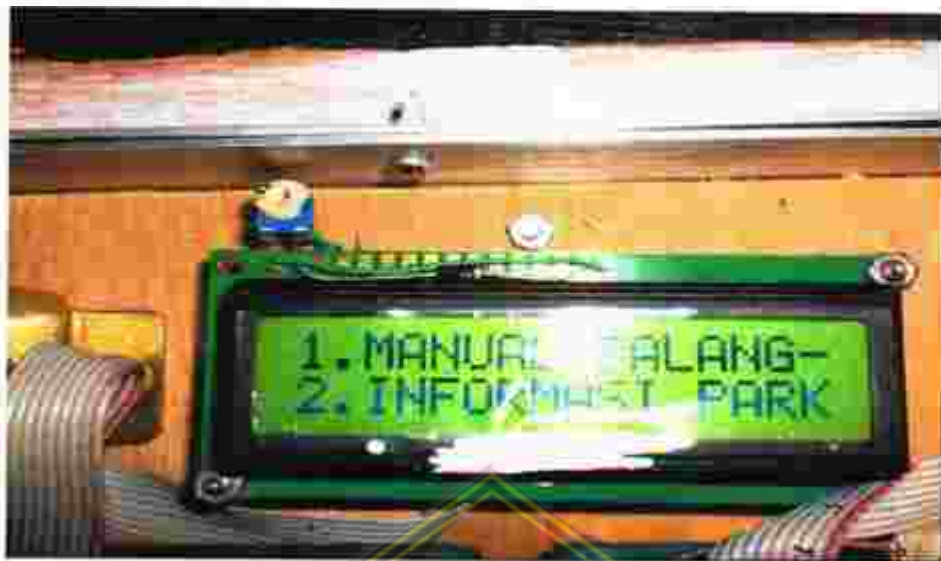
Gambar 4.10 Tampilan menu pengujian sistem Pemantau area parkir tiga lantai
