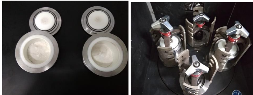
Gambar 1. Proses perubahan serbuk ikan laut dalam bentuk nanopartikel dengan ball milling
