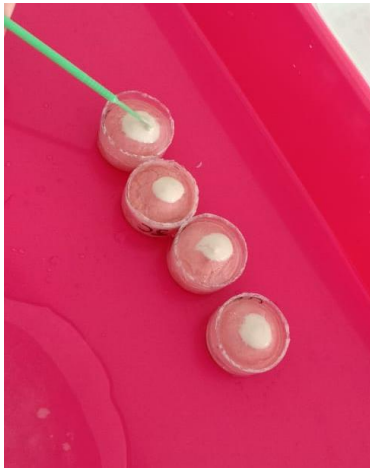
Pengulasan sampel dengan bahan uji
