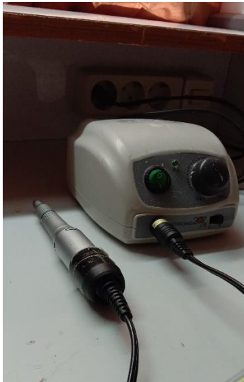
Micromotor dan handpiece untuk pemotongan sampel
