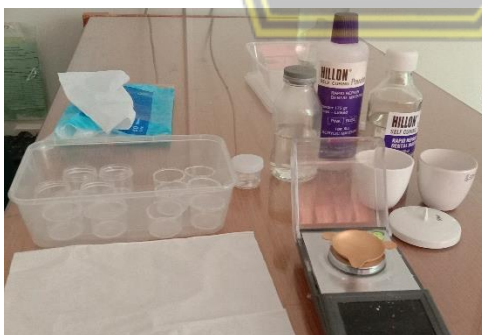
Penanaman sampel pada resin acrylic self-cure
