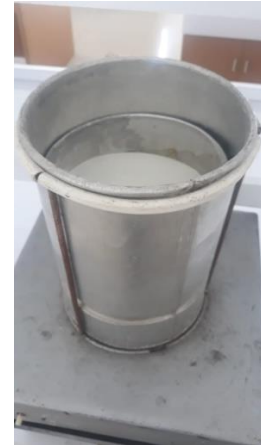
Proses pengayakan serbuk cangkang telur bebek mesh 100 mm
