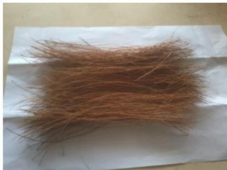
Gambar 2.5. Serat sabut kelapa (Arsyad *et al.*, 2014)
