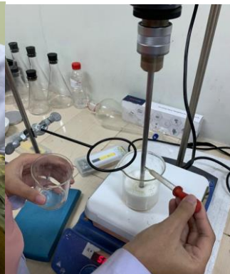
Pengadukan bahan nanoemulsi dengan alat Homogenizer
