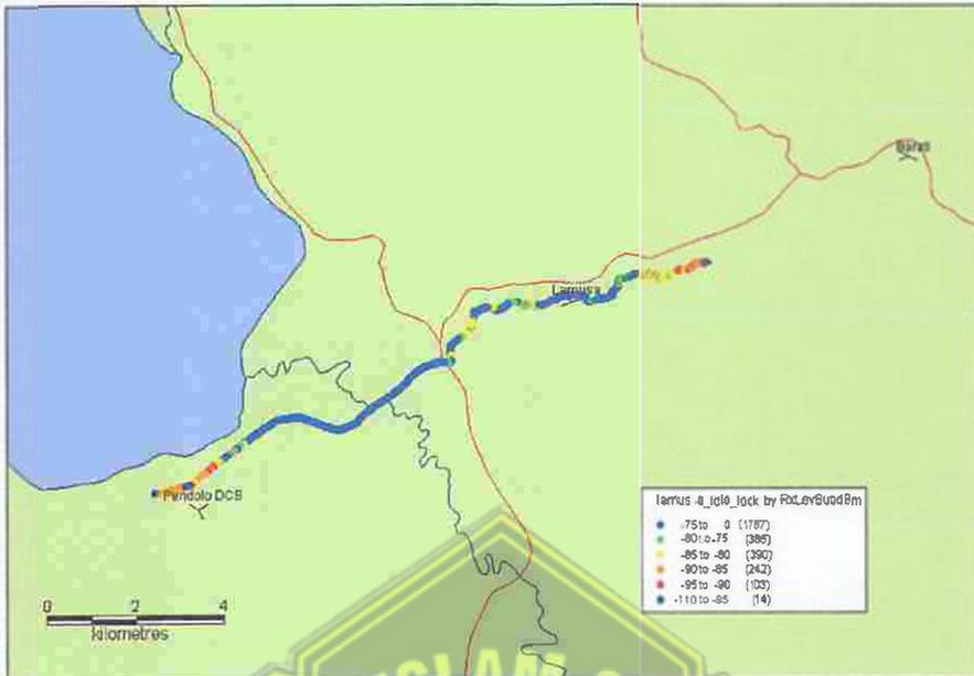
Gambar 3.20 Contoh Plot RxLevel (*Idle Mode*) dari Hasil *Drive Test*
