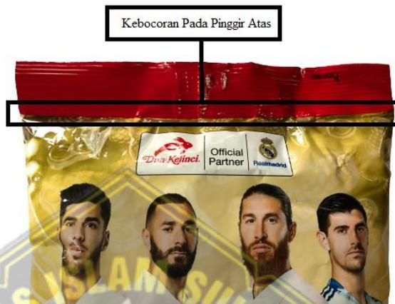
Gambar 4.2 Kebocoran Pada Pinggir Atas
