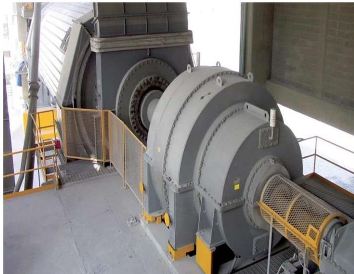
**Gambar 4.1** Komponen *gear box* *Cement Mill* Indarung IV (Data staff perencanaan & evaluasi pemeliharaan, 2020)
