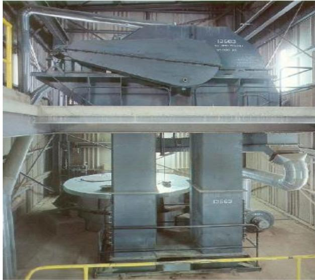
**Gambar 4.6** Komponen *bucket elevator* *Cement Mill* Indarung IV (Data staff perencanaan & evaluasi pemeliharaan, 2020)
