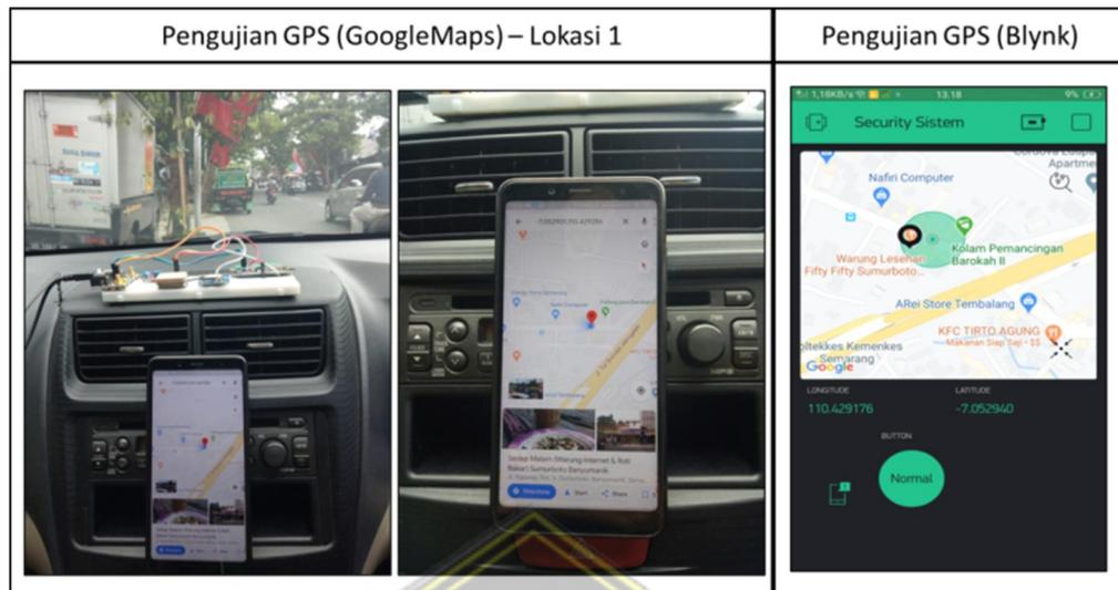
Gambar 4.10 Pengujian sensor lokasi GPS (lokasi 1)
