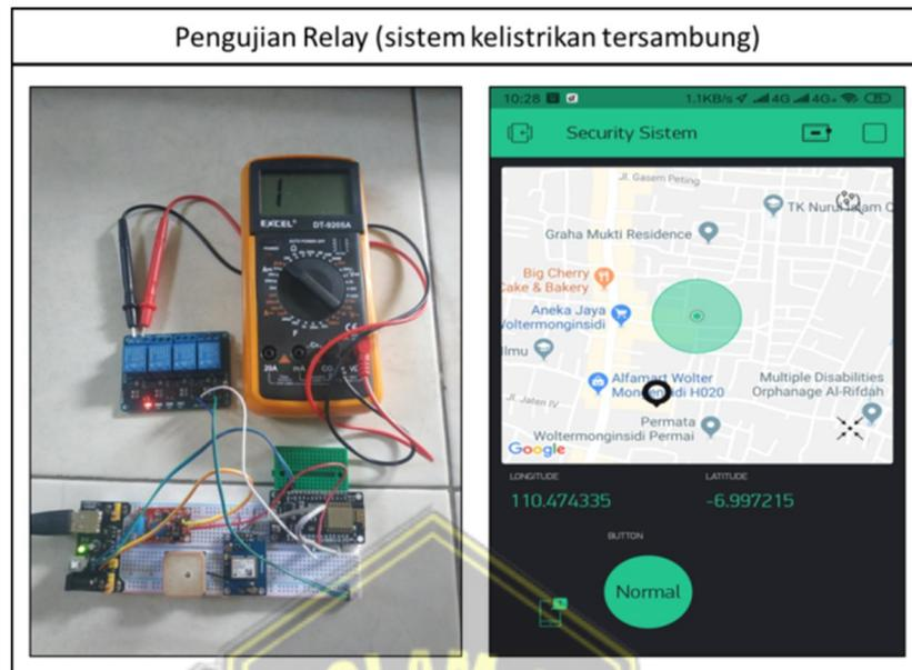
Gambar 4.18 Pengujian relay (kondisi normal)
