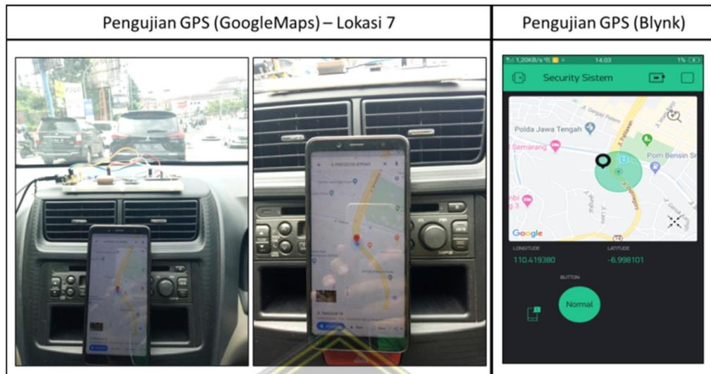
Gambar 4.16 Pengujian sensor lokasi GPS (lokasi 7)
