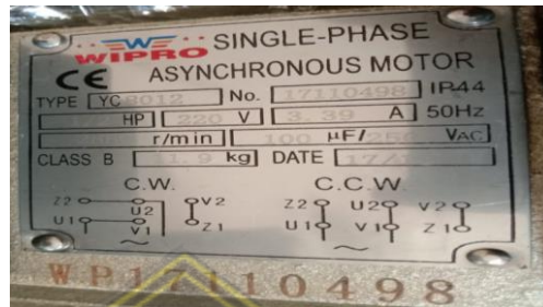
Gambar 1 Foto Nameplate Motor Listrik ½ HP
