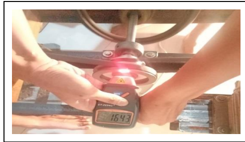
Gambar 18 Foto Pengukuran Kecepatan Pada Flywheel Ketika Generator Diberi Beban (Lampu Pijar 100 W)
