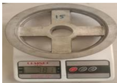
Gambar 9 Foto Katrol Pulley Yang Digerakan ( P_4 ) Diameter 0,150 m
