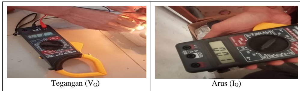
Gambar 22 Foto Pengukuran Tegangan ( V_G ) dan Arus ( I_G ) Ketika Generator Diberi Beban (Lampu Pijar 10 W)
