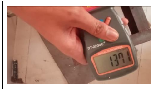
Gambar 26 Foto Pengukuran Kecepatan Putaran ( \omega_G ) Ketika Generator Diberi Beban (Lampu Pijar 10 W)
