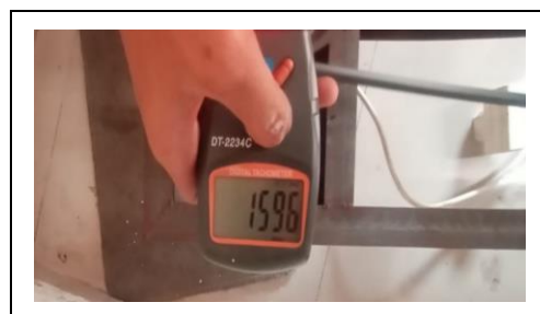
Gambar 25 Foto Pengukuran Kecepatan Putaran ( \omega_G ) Pada Generator Ketika Tanpa Beban
