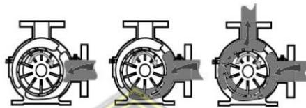
Gambar 2.5 Ilustrasi Kerja Pompa Sentrifugal Tipe Radial
