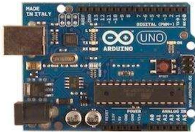
**Gambar 2.18.** Modul Mikrokontroler Arduino
