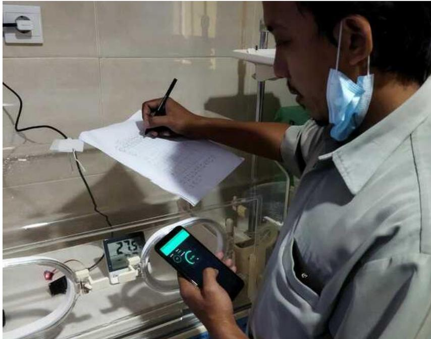
**Gambar 4.12.** Pengujian Sensor Suhu dan Kelembaban DHT 11 pada baby Incubator chamber
