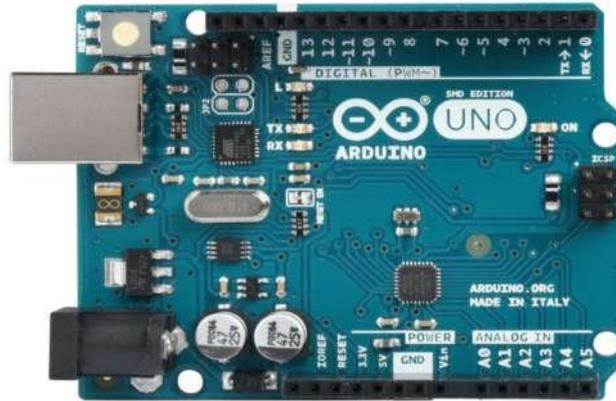
**Gambar 2.7** Papan Mikrokontroler Arduino Uno [17].
