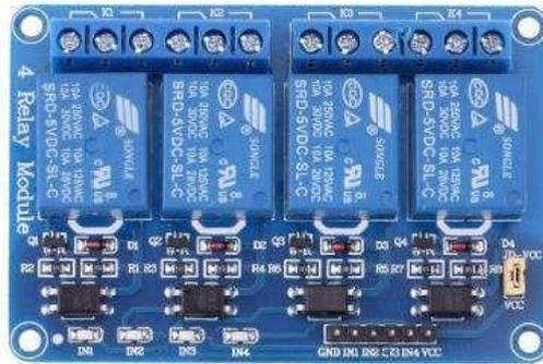
**Gambar 2.13** Modul Relay 4 Channel [28]
