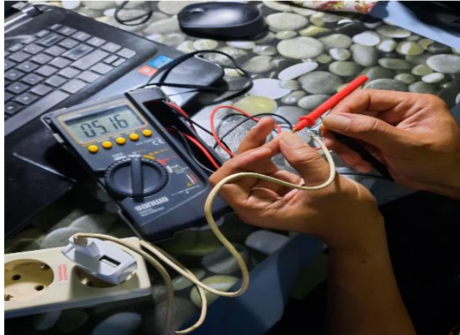
Gambar 4.1. Pengujian Catu daya 5V DC
