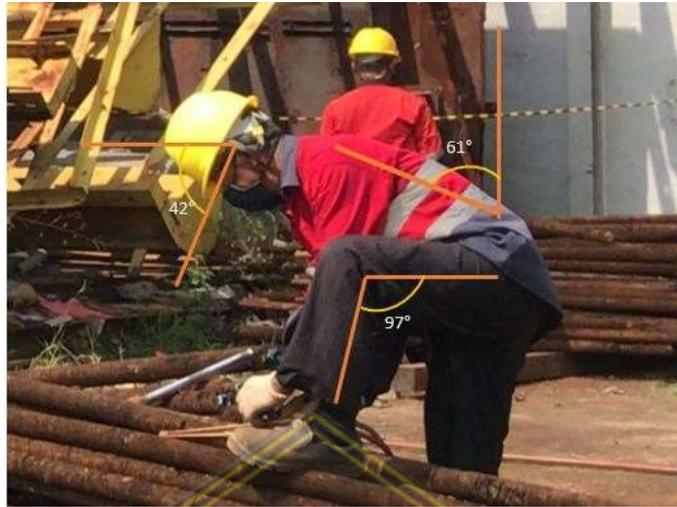
**Gambar 4.3** Proses pemotongan pipa scrap dengan posisi berdiri
