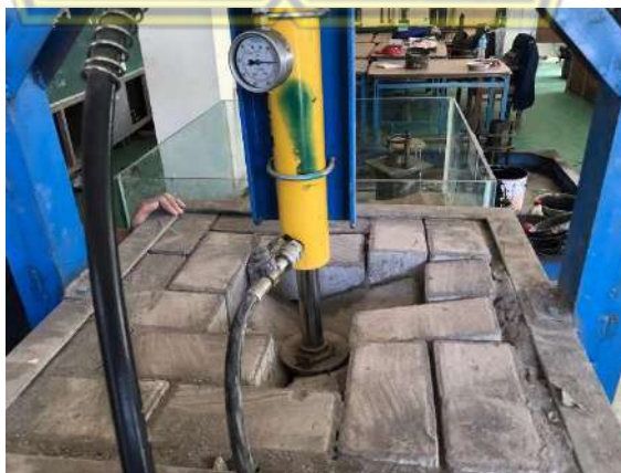
Gambar 4.6 Sesudah diberi gaya vertical pada paving holland
