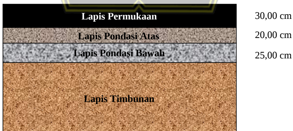
Gambar 4.6 Struktur perkerasan jalan lentur dengan 175 \times 10^6 - 8,16 ton ESAL
