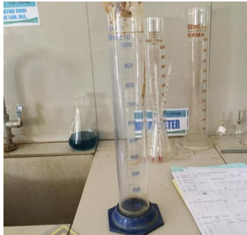
Gambar 3.7 Gelas ukur & Hydrometer Sumber : Dokumentasi pribadi
