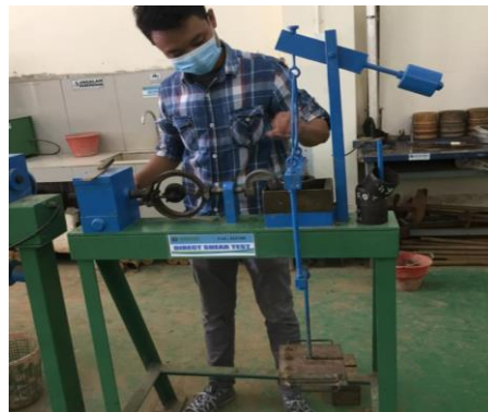
Gambar 3.9 Perangkat direct shear test
