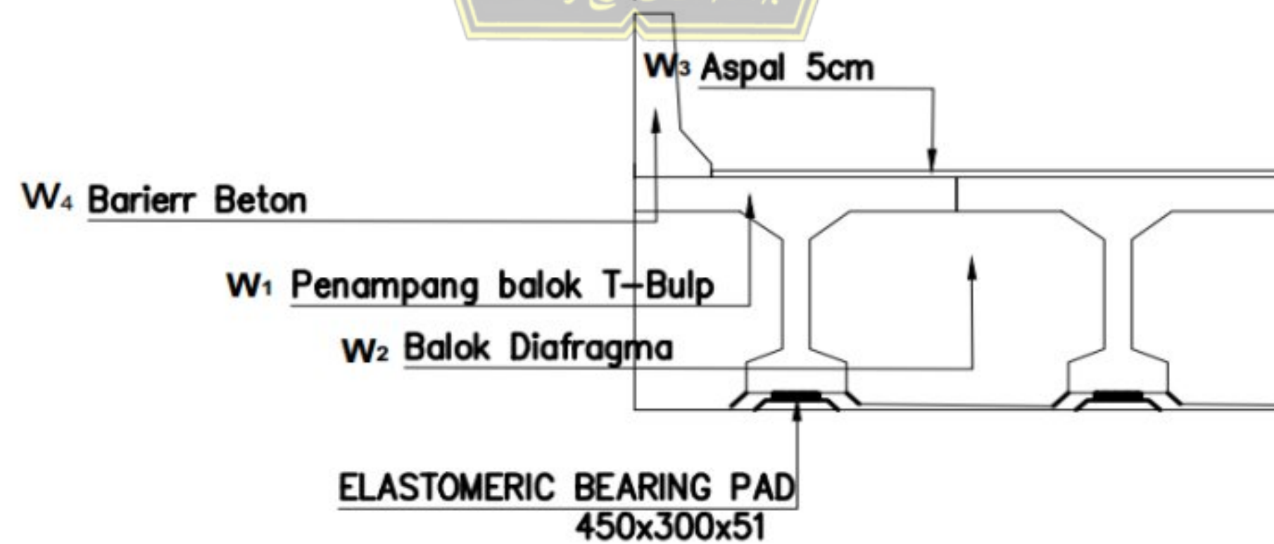
Gambar 3.6. Bagian-bagian jembatan
