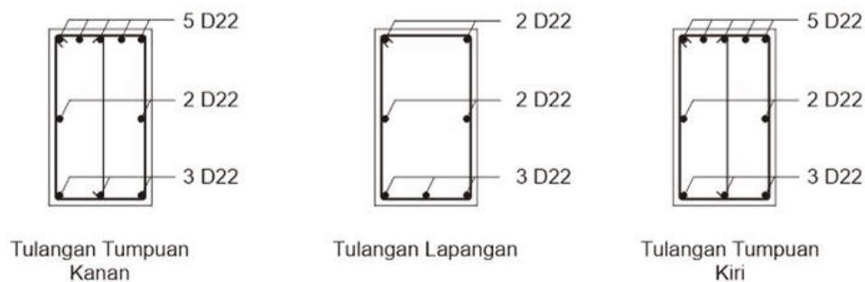
Gambar 4.23 Penulangan Balok G1
