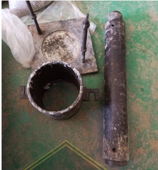
Gambar 2.25 Seperangkat Alat Proctor Test (Sumber: Laboratorium Tanah Fakultas Teknik Unissula)
