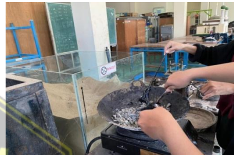
Gambar 3.13 Pencampuran aspal dan agregat
