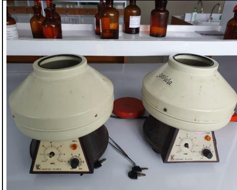
Alat sentrifuge untuk memisahkan darah dan serum
