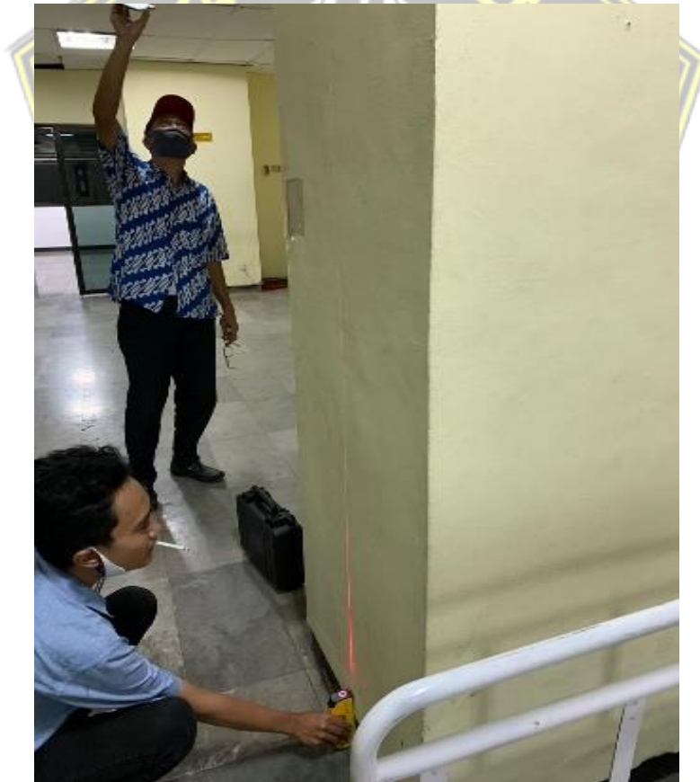
Gambar Cek Kemiringan Kolom
