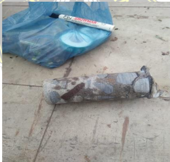
Gambar : Contoh Sampel Inti Beton
