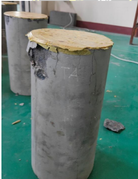
Lampiran 8 : Gambar benda uji setelah proses pengujian kuat tekan beton.
