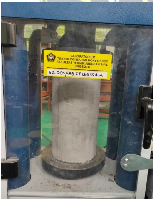
Lampiran 7 : proses pengujian benda uji silinder beton
