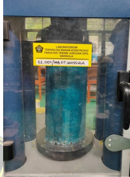
Lampiran 8 : Gambar benda uji setelah proses pengujian kuat tekan beton.
