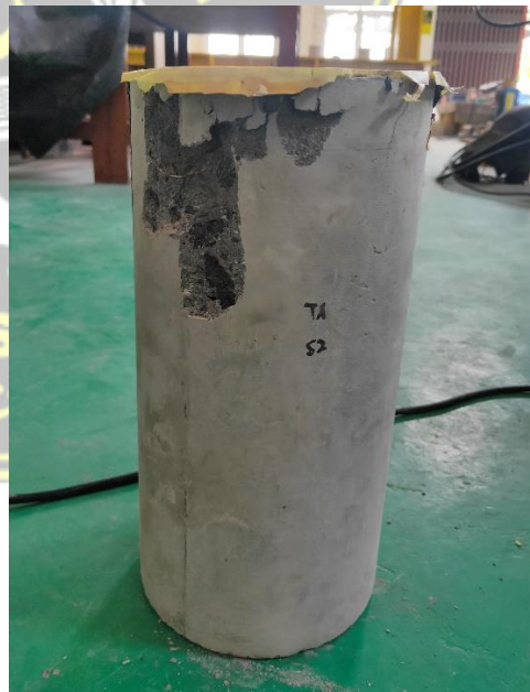
Lampiran 8 : Gambar benda uji setelah proses pengujian kuat tekan beton.
