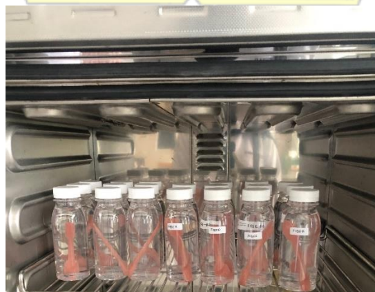
Gambar proses penyimpanan sampel didalam Inkubator selama 24 jam dengan suhu 37 °C
