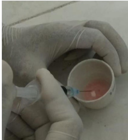
Gambar pencampuran powder dan liquid Resin Akrilik Heat Cured
