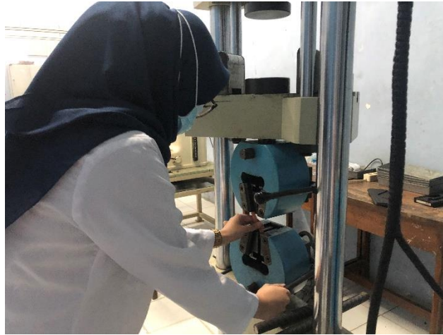
Gambar pengujian Tensile Strength pada sampel dengan menggunakan UTM ( Universal testing Machine )
