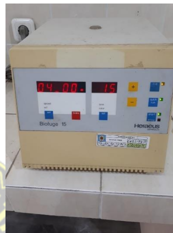
Gambar 5. Sentrifuge untuk memisahkan darah
