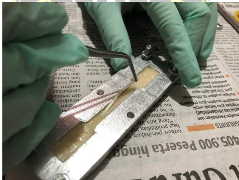
Gambar Aplikasi Resin Komposit prepolymerized dalam pembuatan sampel
