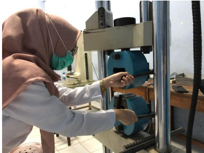
Gambar Uji sampel Resin Komposit Prepolymerized + Non Dental Glass Fiber Dan tanpa Non Dental Glass Fiber saat dilakukan pengujian kekuatan tarik menggunakan Universal Testing Machine (UTM) .
