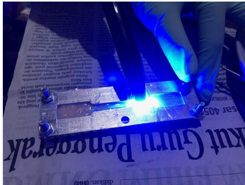
Gambar Proses Light Cure diatas fiber polyethylene Pada spesimen
