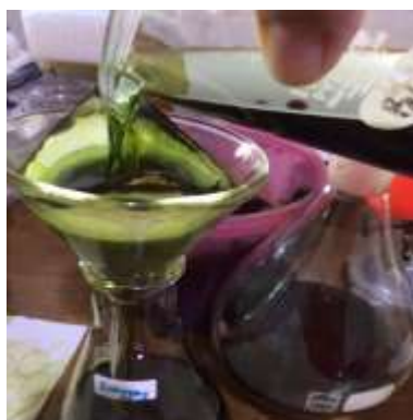
Setelah direndam dalam larutan etil asetat dilakukan penyaringan
