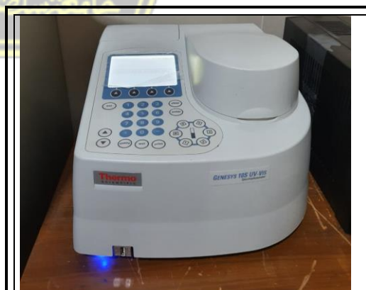
Spektrofotometer UV-VIS untuk membaca absorbansi
