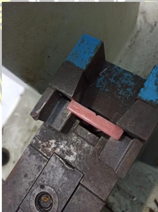
Gambar pengujian Kekuatan Impak dengan menggunakan mesin Impact Tester metode Charpy
