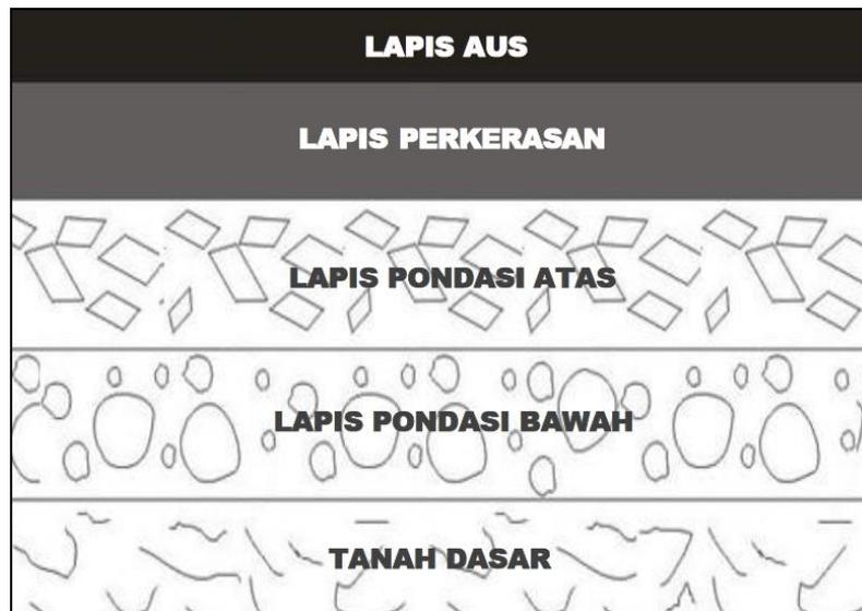
Gambar 1.1. Struktur dasar lapis perkerasan jalan lentur
