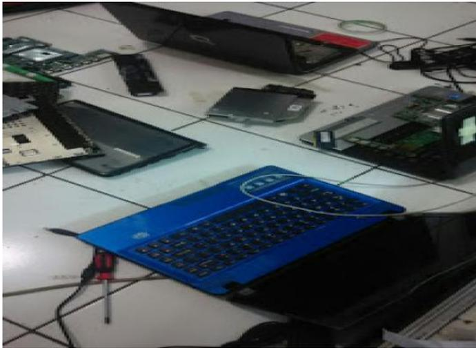
Gambar tersebut adalah proses perbaikan terhadap laptop pelanggan yang mengalami kerusakan pada layar dan tombol.
