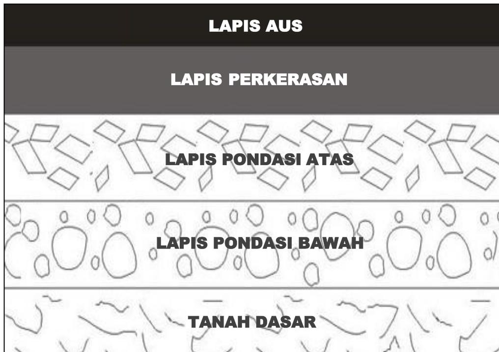
Gambar 1.1 Struktur Dasar Perkerasan Jalan Lentur
