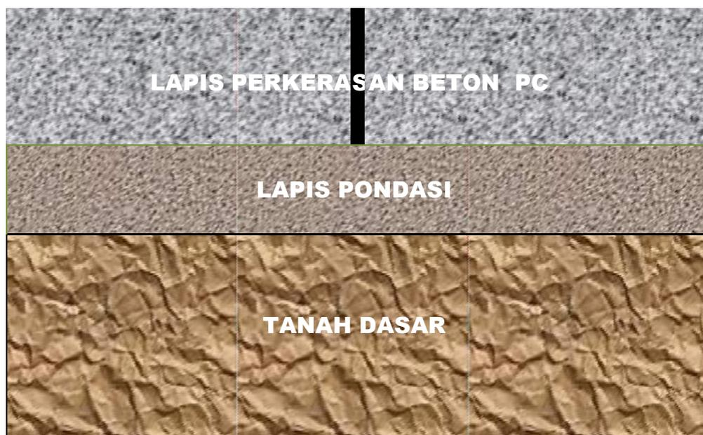
Gambar 1.2. Struktur Dasar Perkerasan Jalan Kaku
