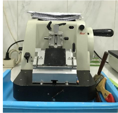
Gambar 12. Parafin dipotong dengan mesin microtome
