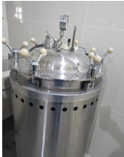
Sterilisasi alat berbahan logam dengan autoclave
