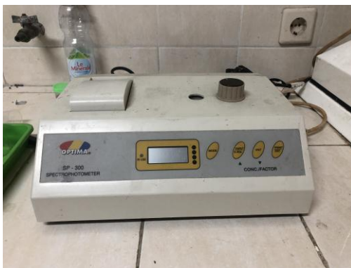
Gambar Spektrofotometer UV-Vis 405nm
