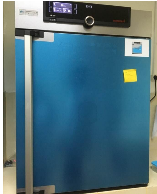
Gambar 6. Proses inkubasi bakteri staphylococcus aureus dalam inkubator selama 24jam dengan suhu 37 derajat
