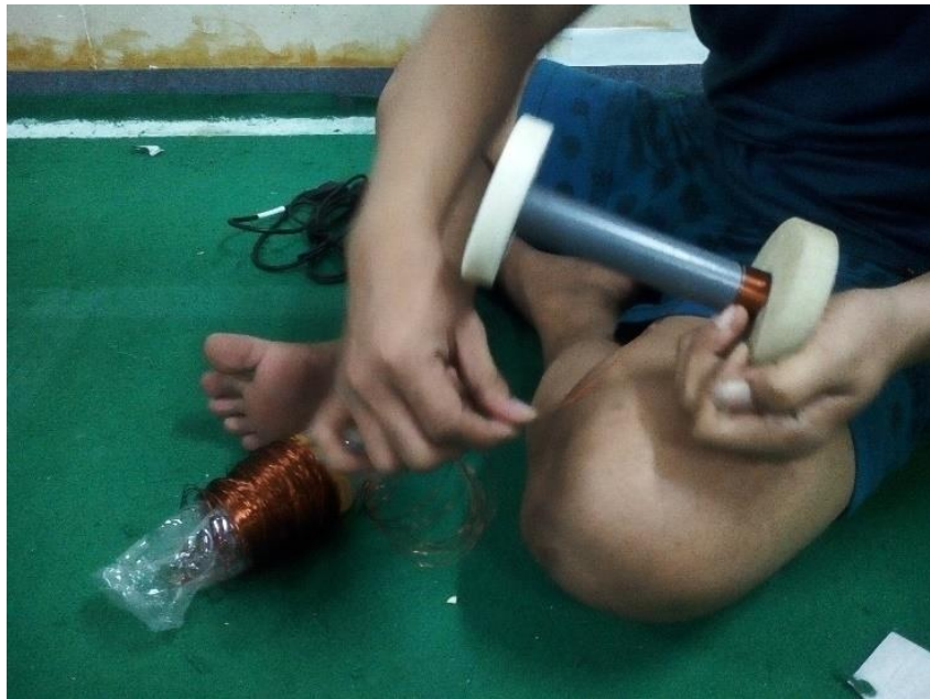
Gambar 1.2 Proses Pelilitan Kawat Tampak Depan
