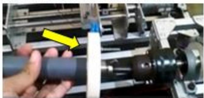
Gambar 5. Pemasangan Kerangka Solenoid
