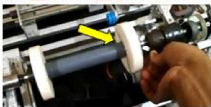
Gambar 7. Penguncian Kawat Pada Kerangka Solenoid
