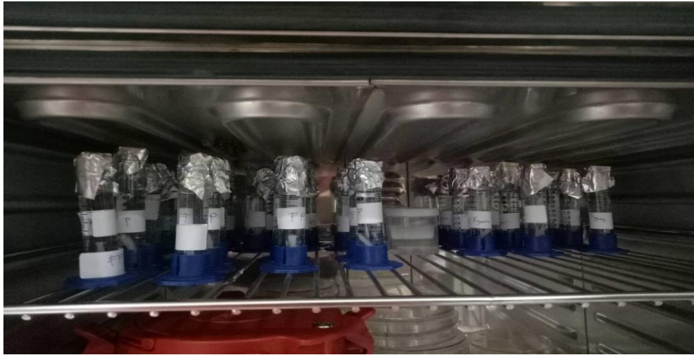
Gambar Penyimpanan Spesimen di Inkubator selama 24 jam dengan suhu 37^{\circ}\text{C}
