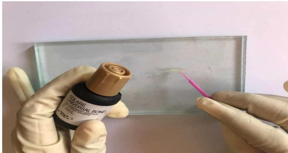
Gambar proses aplikasi coupling agent pada fiber polyethylene
