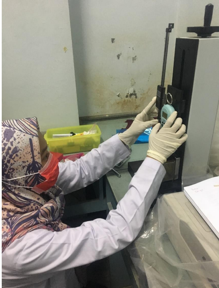
Gambar Uji Spesimen Resin Komposit Prepolymerized + Fiber Polyethylene Dan tanpa Fiber Polyethylene saat dilakukan pengujian kekuatan Fleksural
