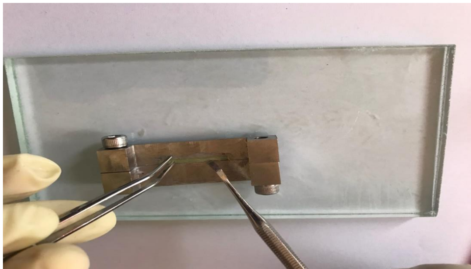
Gambar Proses Aplikasi Fiber Polyethylene dengan posisi horizontal pada 2/3 bagian diantara resin komposit prepolymerized
