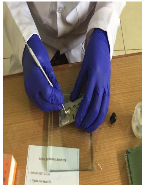
Gambar Aplikasi Resin Komposit Prepolymerized Filler dalam Cetakan Ring Mold Space
