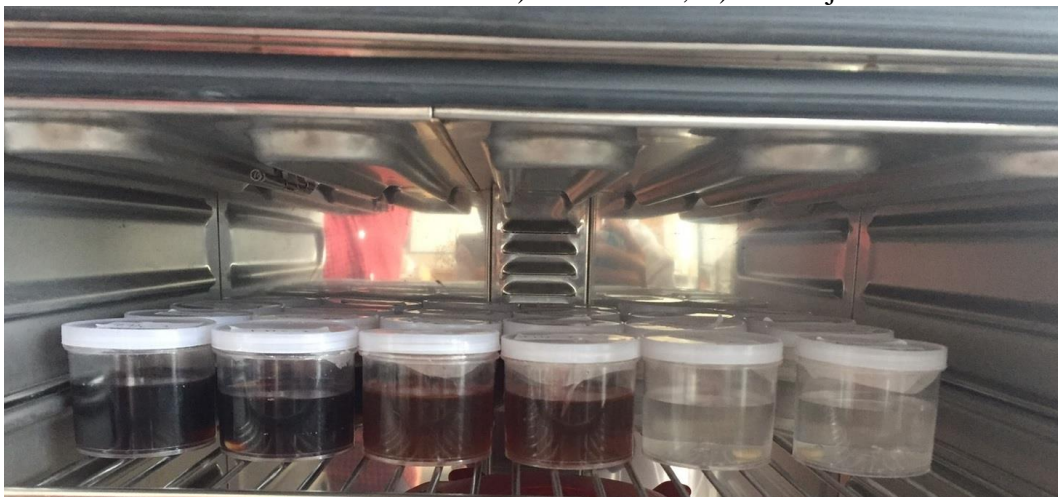
Gambar Penyimpanan Sampel yang Direndam A) Larutan Teh Hitam , B) Larutan Teh Hijau , C) Aquadest di Inkubator selama 24 jam dengan suhu 37^{\circ}\text{C}
