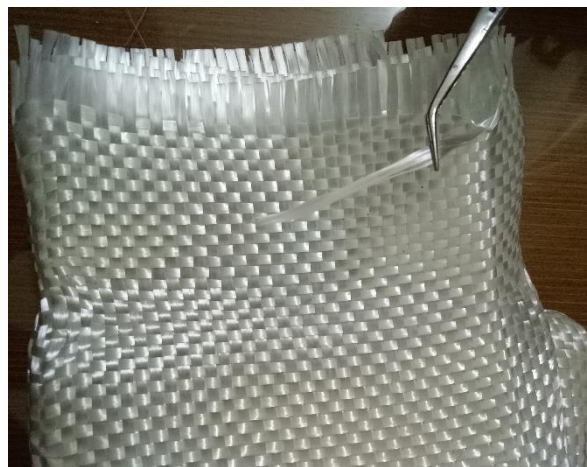
Gambar Non dental glass fiber diambil satu-persatu dengan pinset untuk mendapatkan bentuk benang-benang
