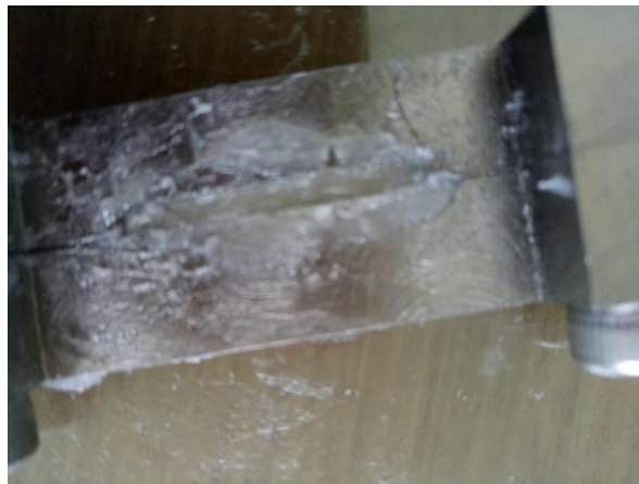
Gambar aplikasi non dental glass fiber yang telah diolesi coupling agent di atas resin komposit prepolymerized
