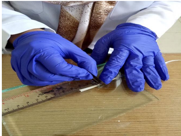
Gambar pengukuran panjang non dental glass fiber dan pemotongan non dental
